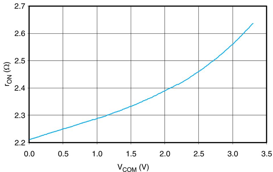
Figure 4. r<sub>ON</sub>(Ω) vs V<sub>COM</sub>(V)
