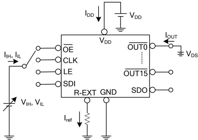
■ TEST CIRCUIT FOR SWITCHING ELECTRICAL CHARACTERISTICS
