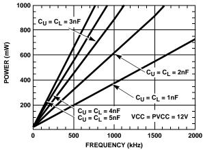
FIGURE 1. POWER DISSIPATION vs FREQUENCY
