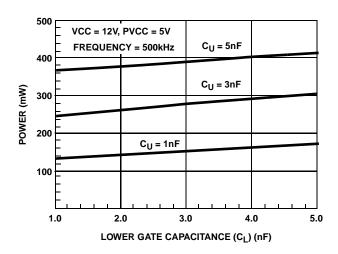
FIGURE 8. POWER DISSIPATION vs LOWER GATE
