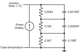
Figure 9a, TRANSIENT THERMAL IMPEDANCE MODEL
