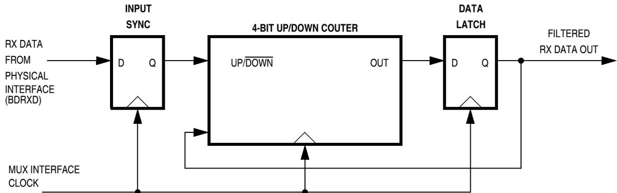
**Figure 4-6. BDLC Rx Digital Filter Block Diagram**
