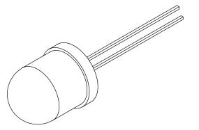
ELECTRO-OPTICAL CHARACTERISTICS Tg=25°C Vf=12V PARAMETER TYP MAX UNITS UNITS PEAK WAVELENGTH 635 nm FORWARD VOLTAGE 12 Vf REVERSE VOLTAGE ۷r 5.0 Ir=100μA AXIAL INTENSITY mcd VIEWING ANGLE EMITTED COLOR: EPOXY LENS FINISH: RED DIFFUSED
