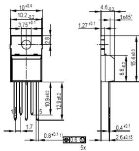
1) 1.0.15 at dam bar (max 1.8 from body) 1) 1.0.15 im Dichtstegbereich (max 1.8 vom Körper)
