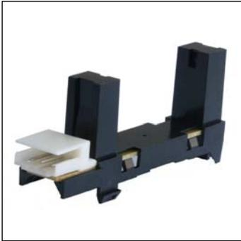
SG2A131は、高出力赤外発光ダイオードと高感度フォトトランジスタを組合わせた透過型フォトインタラプタです。高精度位置検出に適した汎用インタラプタです。
