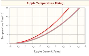
C3216X5R1E106K085AC(100kHz) C3216X5R1E106K085AC(500kHz) C3216X5R1E106K085AC(1MHz)
