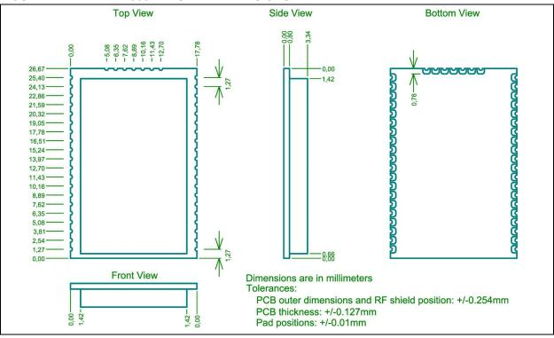
FIGURE 4-2: RECOMMENDED PCB FOOTPRINT
