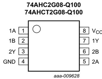
Fig 4. Pin configuration SOT505-2 (TSSOP8) and SOT765-1 (VSSOP8)
