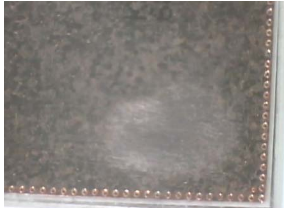
Fig. 5: Acceptable reworked MiniSKiiP bottom surface Abb. 5: Akzeptierbare nachgearbeitete Unterseite eines MiniSKiiPs
