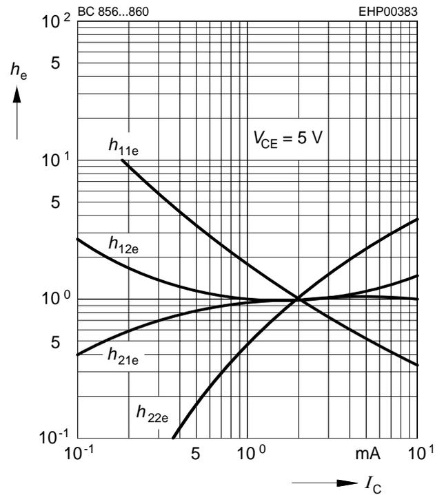
**h parameter  $h_e = f(V_{\text{CE}})$  normalized**
