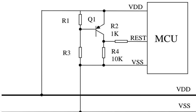
电压偏置复位电路是一种简单的LVR电路，基本上可以解决掉电复位问题。这种复位电路中，R1和 R2 构成分压电路，当VDD高于和等于分压值“ $0.7V \times (R1 + R3) / R1$ ”时，三极管集电极C输出高电平，单片机正常工作；VDD低于“ $0.7V \times (R1 + R3) / R1$ ”时，集电极C输出低电平，单片机复位。对于不同应用需求，选择适当的分压电阻。单片机复位引脚上电压的变化与VDD电压变化之间的差值为 0.7V。如果VDD跌落并低于复位引脚复位检测值，那么系统将被复位。如果希望提升电路复位电平，可将分压电阻设置为  $R3 > R1$ ，并选择VDD与集电极之间的结电压高于0.7V。分压电阻R1和R3在电路中要耗电，此处的功耗必须计入整个系统的功耗中。
