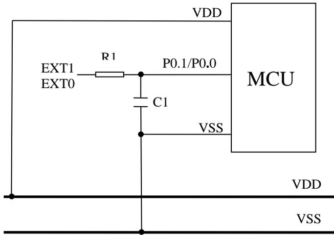
由于外部中断的反应时间很快，当系统外围电压波动时，或系统受到 EMC 干扰时，MCU 可能误进中断，所以需要加上 RC 滤波电路。用户可根据外部中断所采样的信号频率选择不同的 R1 和 C1，以提高系统抗 EMC 能力。
