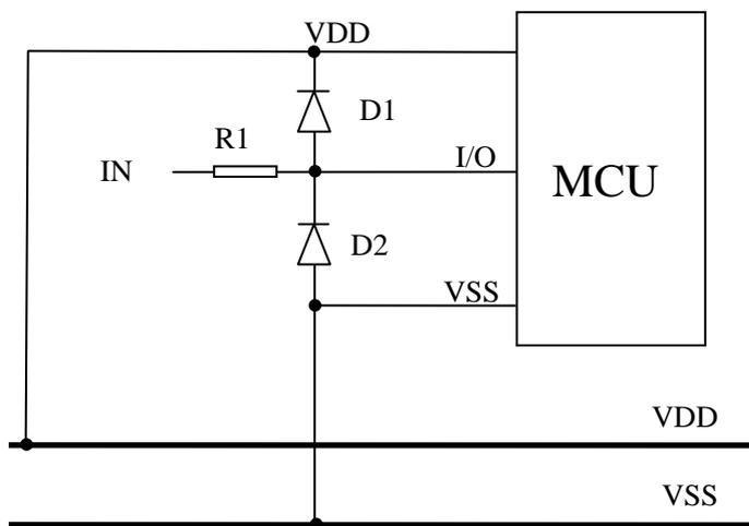
4. 若在 I/O 口线上串入较长的连接线，请在靠近芯片 I/O 的地方加上限流电阻以增强 MCU 抗 EMC 能力
