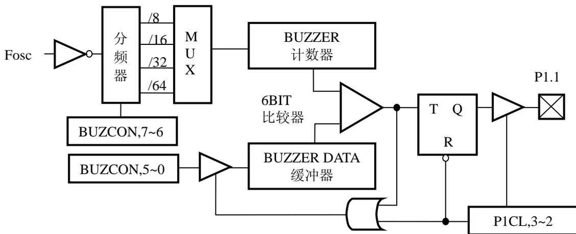
设置 P1, 1 的控制寄存器，即将 P1CL 的 B3, B2 设为 01，可使蜂鸣输出功能处于使能状态，当蜂鸣输出使能时，6-BIT 计数器被清零，PC, 1 输出状态为 0，开始往上计数。如果计数器值和周期数据 (BUZCON. 5-0) 相符，则 PC. 1 输出状态被固定，计数器被清零。另外，6-BIT 计数器溢出也可使计数器清零，BUZCON. 5-0 决定输出频率。BUZZER 输出时序图
