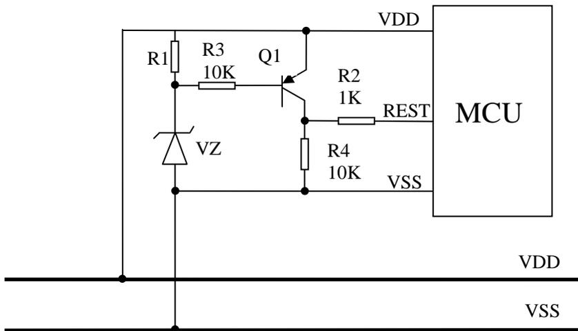
稳压二极管复位电路是一种简单的 LVR 电路，基本上可以解决掉电复位问题。如上图电路中，利用稳压管的击穿电压作为电路复位检测值，当 VDD 高于“ $V_z + 0.7V$ ”时，三极管集电极输出高电平，单片机正常工作；当 VDD 低于“ $V_z + 0.7V$ ”时，三极管集电极输出低电平，单片机复位。稳压管规格不同则电路复位检测值不同，根据电路的要求选择合适的二极管。
