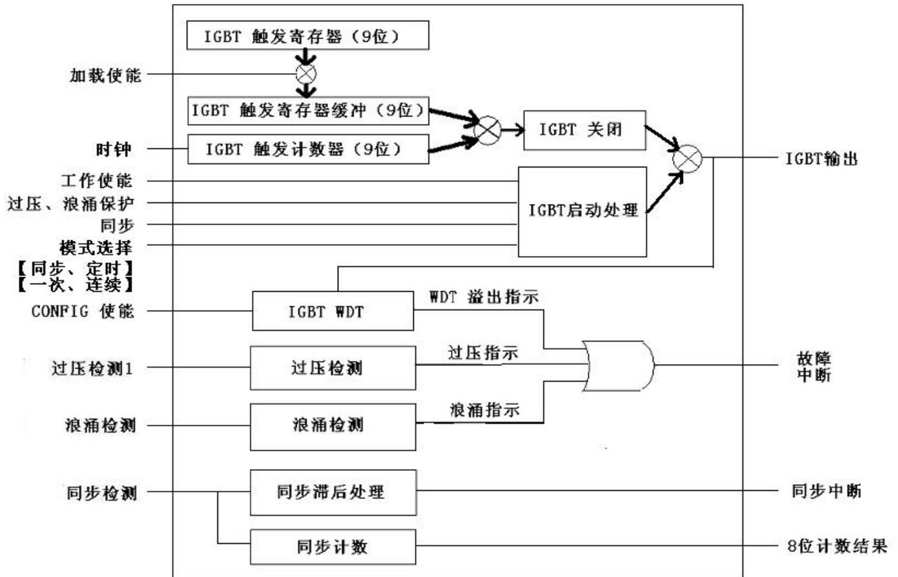
由上图可知, PPG 时序控制主要由 PPG 定时器、同步比较器 (COMP1)、过压比较器 (COMP2)、浪涌比较器 (COMP4) 以及 IGBT WDT 一起控制。
