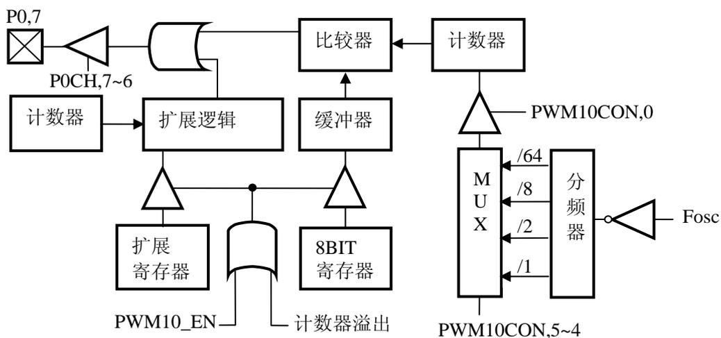
当计数器的低 8 位和相关的寄存器 (PWM10DATA) 匹配时, PWM 输出低电平。如果 PWM10DATA 寄存器的值不是 0, 计数器的低 8-BITS 溢出将使 PWM 输出高电平。这样的话, 写进相关寄存器的值就决定了模块的基本工作周期。
