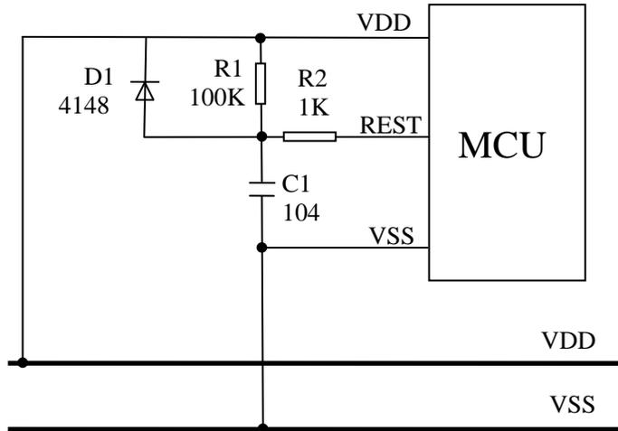
上图中，R1和C1同样是为复位引脚提供输入信号。对于电源异常情况，二极管正向导通使C1快速放电并与 VDD保持一致，避免复位引脚持续高电平、系统无法正常复位。
