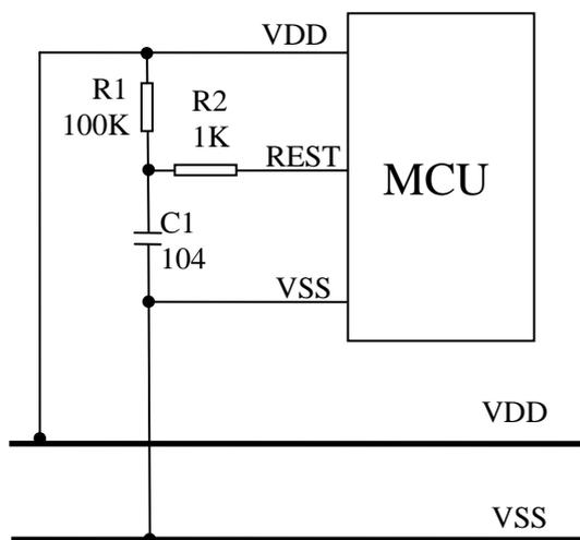
上图为一个由电阻R1和电容C1组成的基本RC复位电路，它在系统上电的过程中能够为复位引脚提供一个缓慢上升的复位信号。这个复位信号的上升速度低于VDD的上电速度，为系统提供合理的复位时序，当复位引脚检测到高电平时，系统复位结束，进入正常工作状态，当系统选择LVR禁止模式时，用户可选用此电路以提高复位的可靠性。
