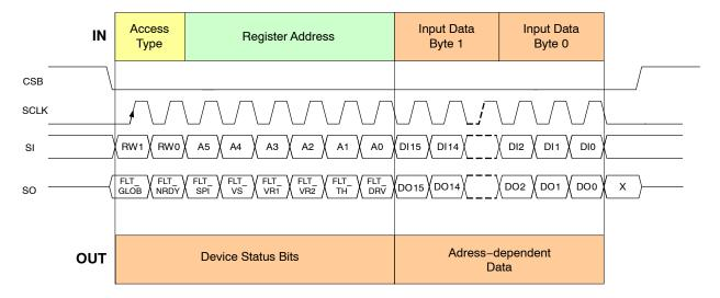
Figure 18. SPI Frame
