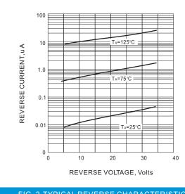
FIG. 2-TYPICAL REVERSE CHARACTERISTICS
