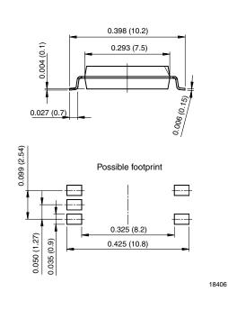
Fig. 3 - SOP-6, 5 Pin Wide Body
