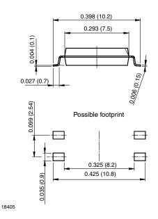
Fig. 9 - SOP-6, 4 Pin Wide Body
