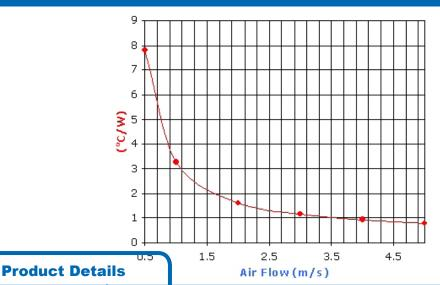
LENGTHWIDTHHEIGHTFIN SPACINGBASE THICKNESSFINISH406.4 mm101 mm14.5 mm3.35 mm5 mmNONE
