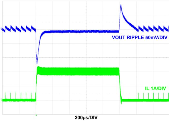
**FIGURE 45. LOAD TRANSIENT**
