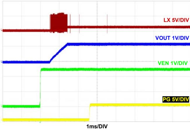
FIGURE 21. START-UP AT NO LOAD
