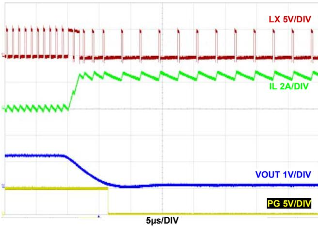
**FIGURE 47. OUTPUT SHORT-CIRCUIT**
