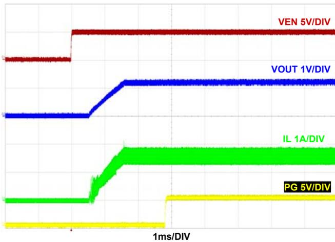
FIGURE 29. START-UP AT 1.5A LOAD
