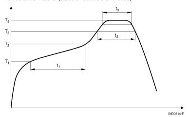
$\mathsf{T}_4$  $T_1$  $T_2$  $T_3$  $t_1$  $t_2$  $t_3$ °C °С °С °C s < 30 @ T<sub>4</sub> -5 °C 150 200 217 245 < 110 < 90
