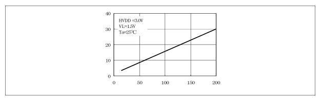
Figure 7-39: Rise Time v.s. Capacitance  $(C_L)$
