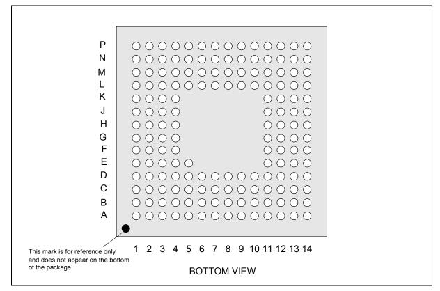
Figure 5-1: S1D13717 FCBGA-161 Pin Mapping
