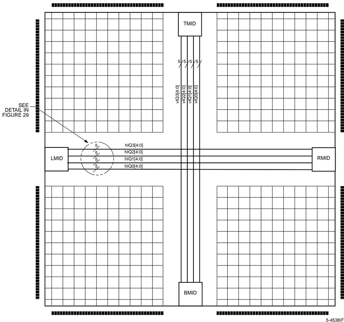
Figure 28. Interquad Routing
