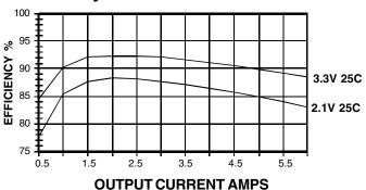
$V_0=3.3V$ ,  $C_{out}$ - $O\mu f$ ,  $V_i=5V$ ,  $C_{in}=100\mu f$
