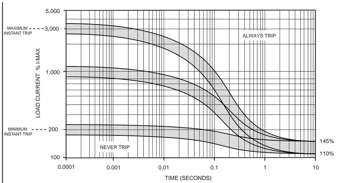
**FIGURE 5. TYPICAL TRIP CHARACTERISTIC SETTINGS**
