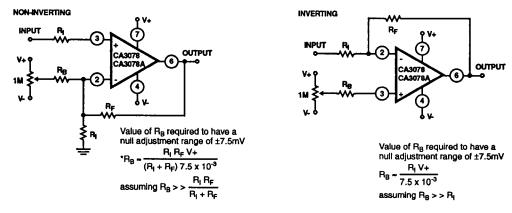
FIGURE 24. OFFSET VOLTAGE NULL CIRCUITS
