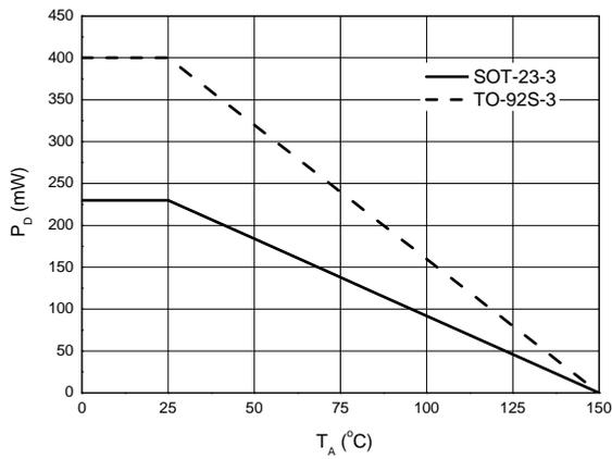
Figure 17. P<sub>D</sub> vs. T<sub>A</sub>
