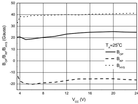
Figure 13. B<sub>OP</sub>/B<sub>RP</sub>/B<sub>HYS</sub> vs. V<sub>CC</sub>
