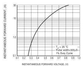
FIG.3 TYPICAL INSTANTANEOUS FORWARD CHARACTERISTICS
