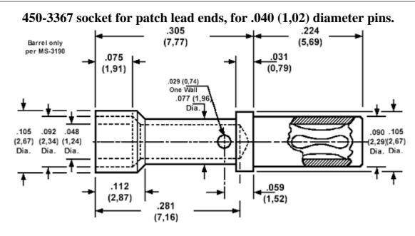
Min hole depth (socket) .185 (4,70)
