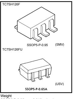
SSOP5-P-0.95 : 0.016 g (typ.) SSOP5-P-0.65A : 0.006 g (typ.)
