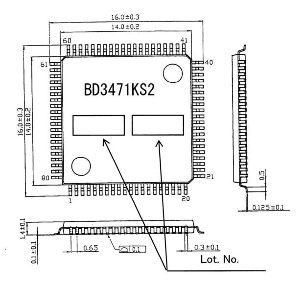
Fig-1 外形寸法図 (Outside dimension)
