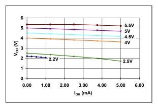
FIGURE 2-27: V<sub>OH</sub> vs. I<sub>OH</sub> (MCP1316-2.0 @ 25C).
