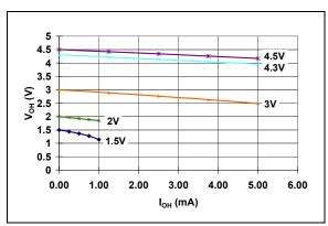
FIGURE 2-25: V<sub>OH</sub> vs. I<sub>OH</sub> (MCP1318M-4.6 @ 25C).
