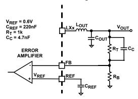
FIGURE 6. OUTPUT VOLTAGE SELECTION
