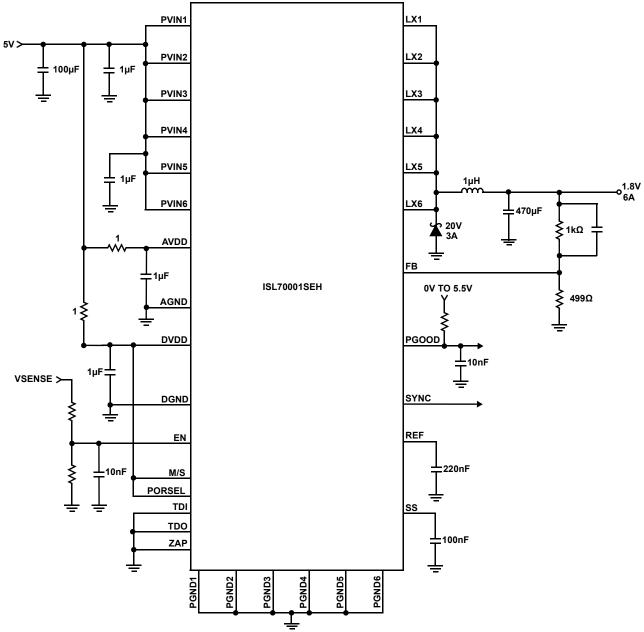
FIGURE 3. 5V INPUT SUPPLY VOLTAGE WITH MASTER MODE SYNCHRONIZATION
