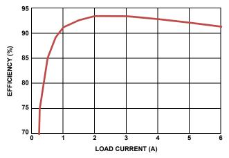
FIGURE 2. EFFICIENCY 5V INPUT TO 3.3V OUTPUT,  $T_{\Delta} = +25 \,^{\circ}\text{C}$
