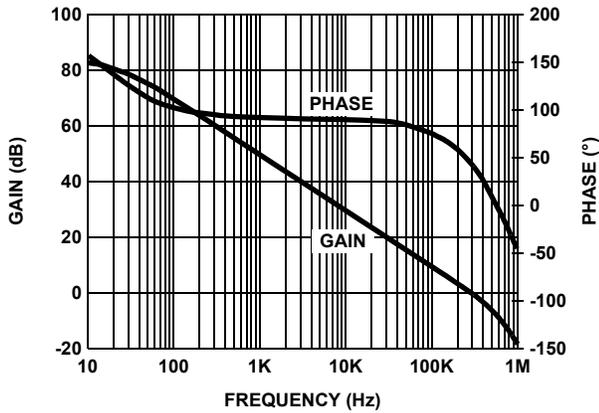
FIGURE 7.  $A_{VOL}$  vs FREQUENCY @ 1k $\Omega$  LOAD
