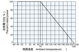
周囲温度70℃以上で使用される場合は、上図に示す負荷軽減曲線に 従って、定格電力を軽減して御使用下さい。
