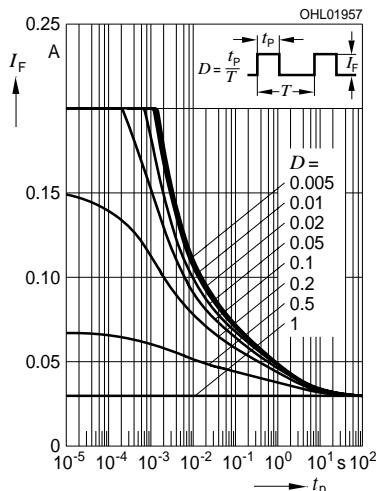
**Zulässige Impulsbelastbarkeit  $I_F = f(t_p)$** **Permissible Pulse Handling Capability**Duty cycle  $D$  = parameter,  $T_A = 25^\circ\text{C}$
