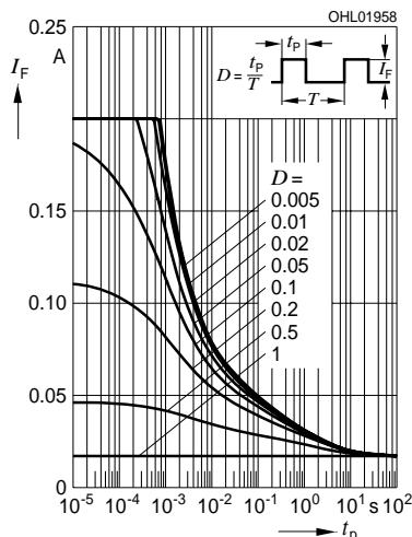
**Zulässige Impulsbelastbarkeit  $I_F = f(t_p)$** **Permissible Pulse Handling Capability**Duty cycle  $D$  = parameter,  $T_A = 85^\circ\text{C}$
