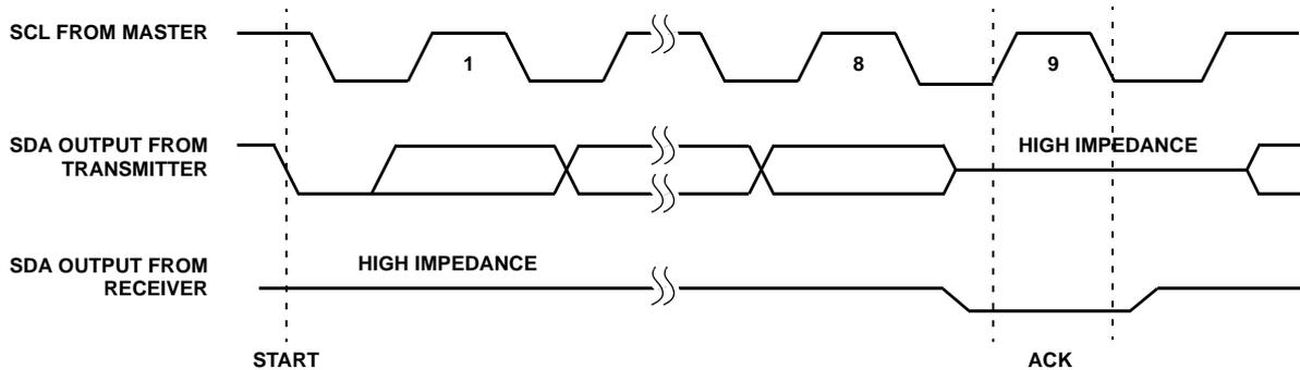
FIGURE 7. ACKNOWLEDGE RESPONSE FROM RECEIVER
