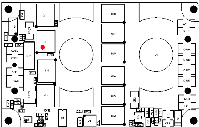
The hottest component on the top side: Q13
