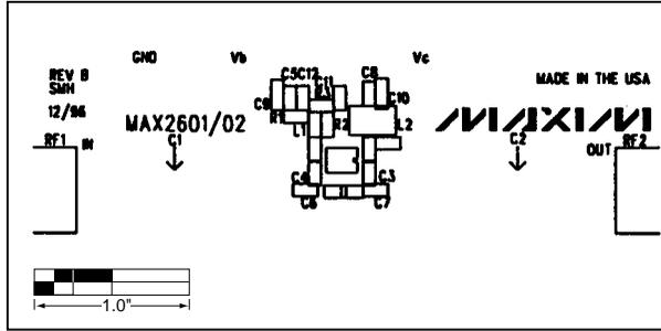
図3. MAX2602 EVキットの部品配置図
