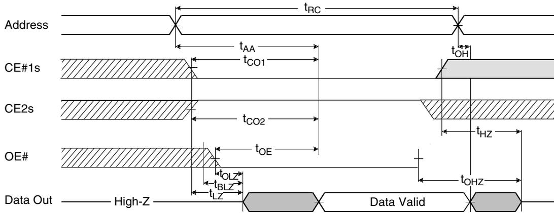
Figure 30. SRAM Read Cycle
