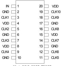
20 pin SOIC, SSOP, TSSOP
