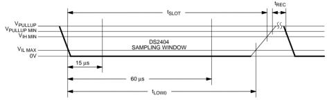
$60 \ \mu s \le t_{LOW0} < t_{SLOT} < 120 \ \mu s$  $1 \mu s \leq t_{REC} < \infty$
