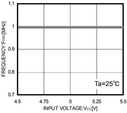
Fig. 12 V<sub>cc</sub> - F<sub>osc</sub>
