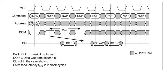
Figure 20 READ Burst - DQM Operation
