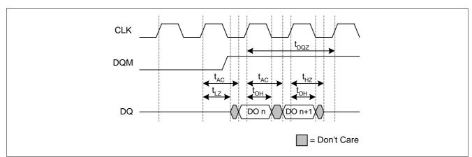
Figure 12 Basic READ Timing Parameters for DQs
