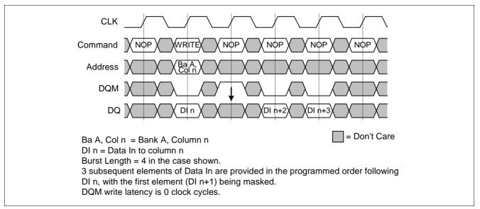
Figure 32 WRITE Burst - DQM Operation
