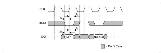
Figure 24 Basic WRITE Timing Parameters for DQs
