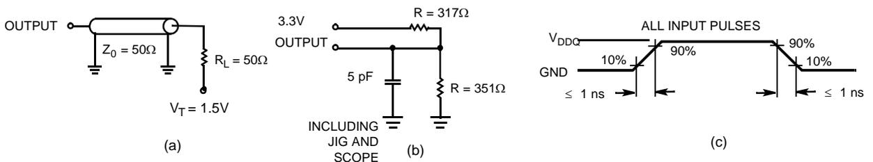
**2.5V I/O Test Load**
