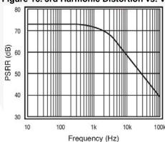
Figure 18. PSRR V<sub>S</sub>=5V
