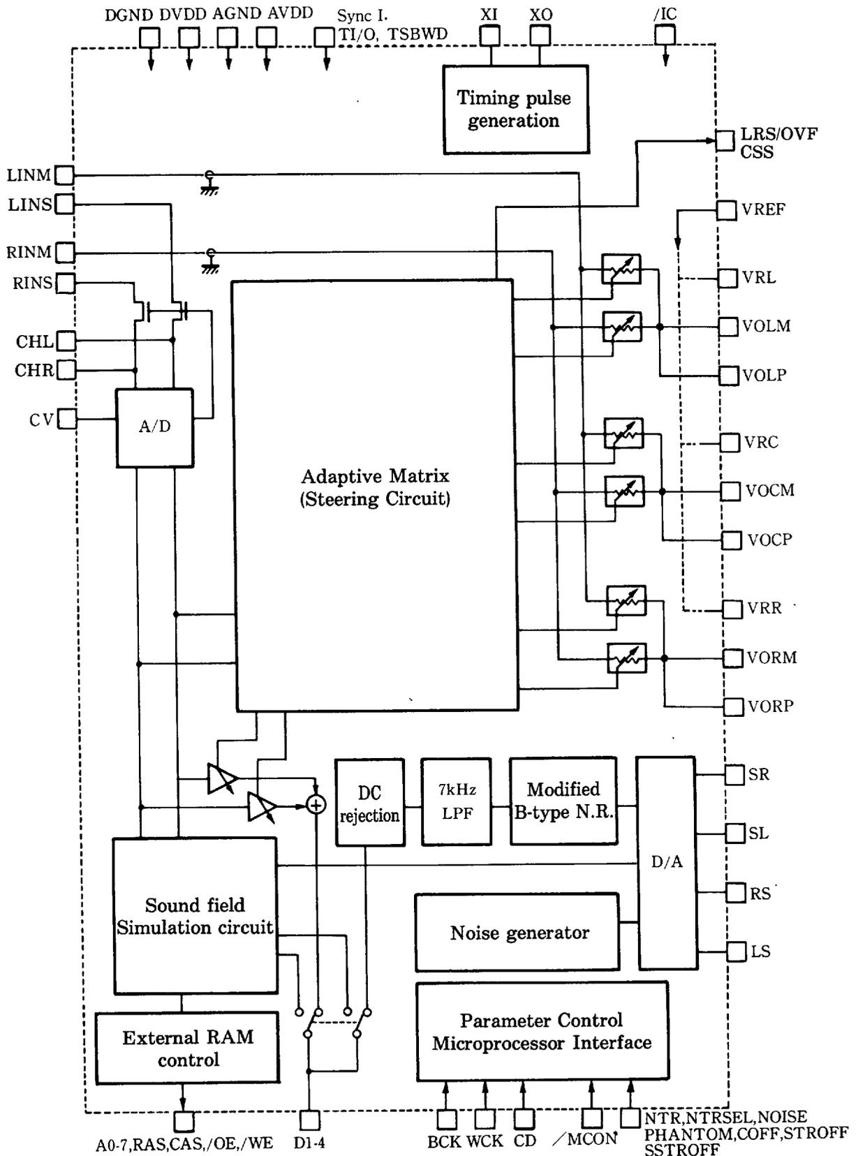
■ SOUND FIELD SIMULATION CIRCUIT BLOCK DIAGRAM
