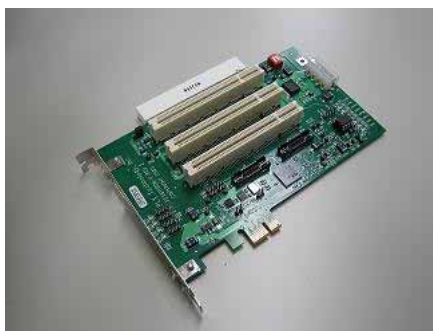
PEX8111 評価ボード (Forward Bridge)
