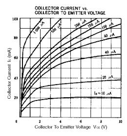
COLLECTOR CURRENT vs. COLLECTOR TO EMITTER VOLTAGE
