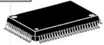
Outline 80P6N 0.8mm pitch QFP (20.0mm×14.0mm×2.8mm)
