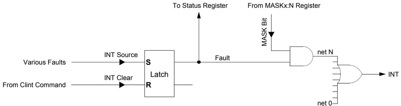
**Figure 20. Interrupt Handling**
